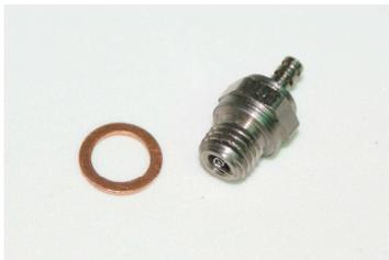
En los motores glow normalmente usados en aerodelismo y automodelismo, se utilizan bujías incandescentes, que tienen la función de inducir la explosión de la mezcla combustible, cuando esta se encuentra a alta presión.
